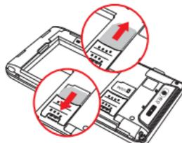
배터리 커버를 뺀 후 USIM 카드의 금색칩이 아래쪽으로 위치하며, 카드 모서리의 각인 부분이 그림처럼 되도록 방향을 잘 확인한 후 홈에 맞춰 화살표 방향으로 밀어 넣습니다.
